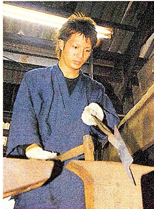
包丁のひねりなどを直す作業に取り組む宮崎さん。五島市、宮崎鍛冶屋
